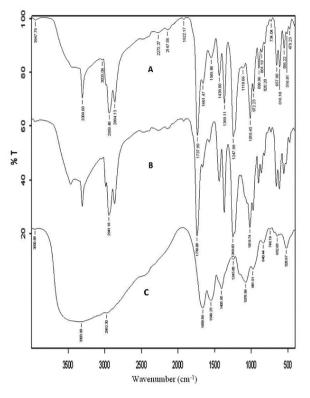
Figure 7. FT-IR spectra of A) ETH-HSA, B) ETH and C) HSA.
