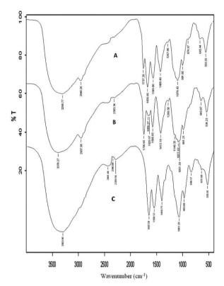
Figure 6. FT-IR spectra of A) OUB-HSA, B) OUB and C) HSA.
