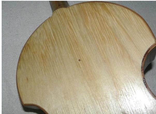
**Fig. 5:** O construtor furou a placa a ser usada como fundo do instrumento com a finalidade de facilitar o corte (centro da imagem). Nesta imagem também é possível observar que a borda do fundo, como a do tampo, é contornada pelas laterais.
