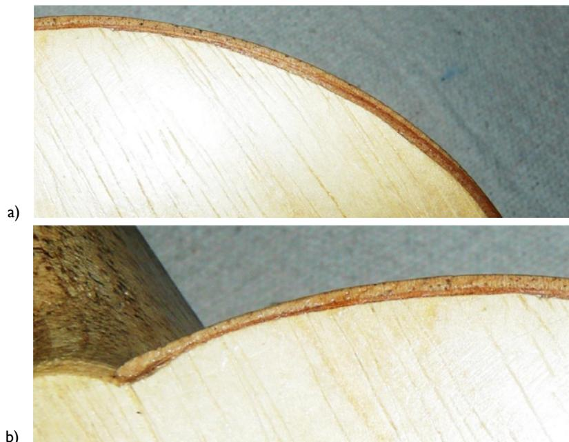
**Fig. 7:** Detalhe das laterais do instrumento. Na imagem a) é possível ver as três faixas do material da lateral de madeira. Na imagem b), numa área próxima do braço, a lâmina interna desaparece. A espessura da faixa central permanece constante por toda a extensão.
