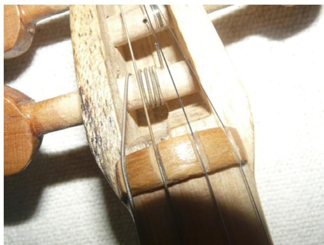
**Fig. 2:** O braço colado apresenta assimetrias na parte interna da caixa das cravelhas (veja-se a área acima da pestana)
