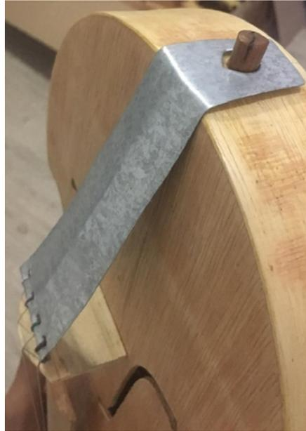
**Fig. 10:** Cavalete sem pés num instrumento de Airon Galindo. O estandarte, de ferro galvanizado, tem uma dobra na parte que fica em contato com a borda do tampo. Acima, é possível ver à direita o botão que dá sustentação ao estandarte.
