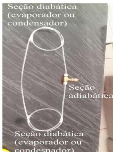
(a) 1 volta na seção adiabática e 2 voltas na seção diabática.
