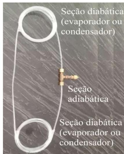
(b) 1 volta na seção adiabática e 10 voltas na seção diabática.
