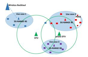
Fig. 1. Generic spectrum sensing scenario.
