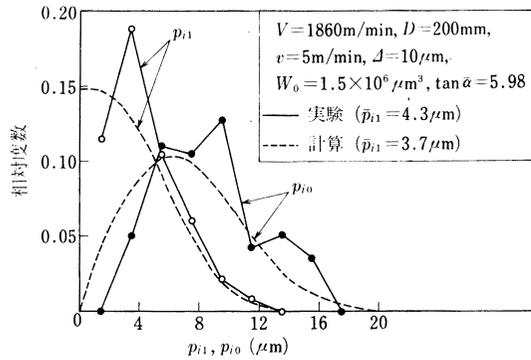
図9 研削仕上面あらさのピッチの実測結果の一例
