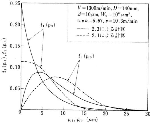
図5 研削仕上面あらさの半ピッチおよび全ピッチの確率密度関数(あらさ曲線の山, 谷点の出現をランダムと仮定した場合)
