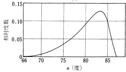
図7 砥粒切れ刃の位置および半頂角の分布モデル
