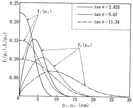
図3 研削仕上面あらさの半ピッチおよび全ピッチの確率密度関数
