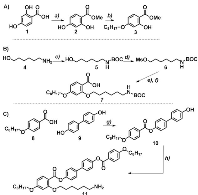
**Scheme 1.** Synthesis of the liquid-crystal ligand: a)  $\text{H}_2\text{SO}_4$ , MeOH; b) 1-bromooctane,  $\text{K}_2\text{CO}_3$ , 2-butanone; c)  $(\text{BOC})_2\text{O}$ , DCM; d) MsCl, TEA, DCM; e) KOtBu, KI, 2-butanone; f) NaOH, MeOH; g) DMAP, EDCl, TEA, THF; h)  $\text{SOCl}_2$ , toluene
